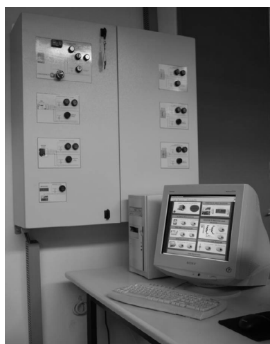
Σχήμα 3: Αυτοματοποιημένος ηλεκτρικός πίνακας επιλογής ηλεκτρικών συνδέσεων και κονσόλα ελέγχου αυτού.
