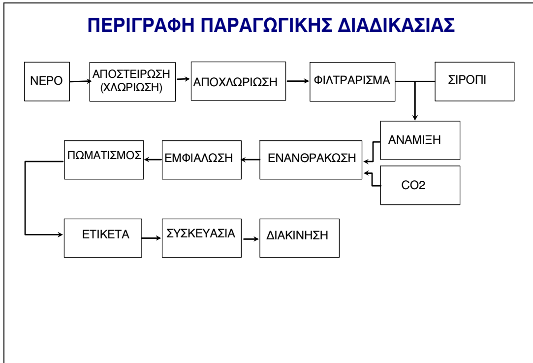
Σχήμα 1. Περιγραφή της παραγωγικής διαδικασίας σε εργοστάσιο αναψυκτικών
